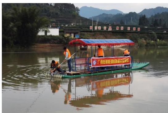
锂离子电池纯电动竹筏试航
